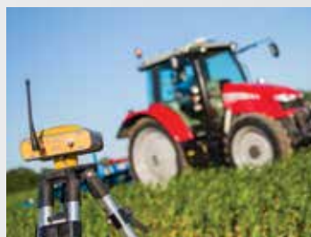
Základní stanice RTK
