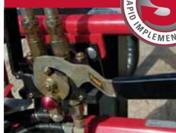
Zahlreiche der erhältlichen Arbeitsgeräte sind mit Selecto-Fix ausgerüstet. Dieses System erlaubt den schnellen, einfachen und zuverlässigen Anschluss der Hydraulik. Kein Austreten von Hydrauliköl oder Vertauschen von Leitungen.
