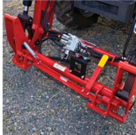
**SafeLock zur automatischen Verriegelung der Anbaugeräte**
