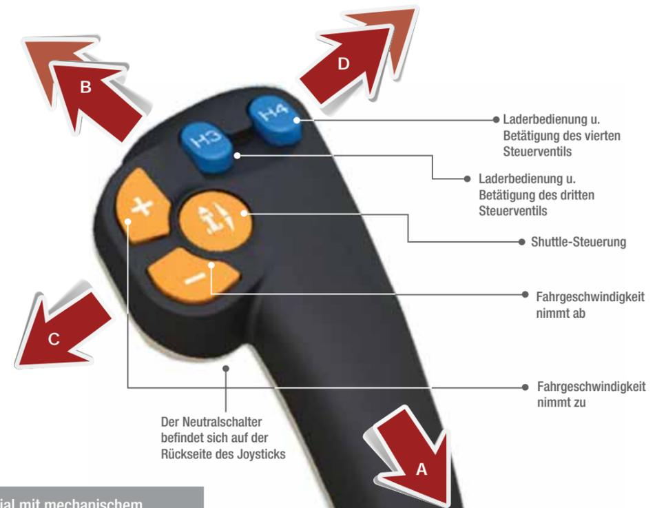
Der Neutralschalter befindet sich auf der Rückseite des Joysticks
