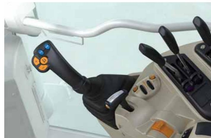
Baureihe MF 7600 in der Version Efficient mit elektrohydraulischem Multifunktions-Joystick und Armlehne
