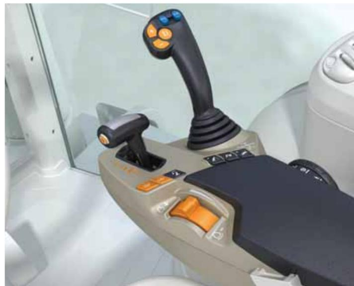
Baureihe MF 7600 in der Version Exclusive mit MultiPad-Hebel und elektrohydraulischem Multifunktions-Joystick (auf der rechten Seite)
