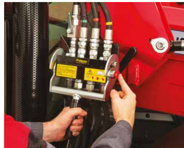
Odpojte hydraulické přípojky a elektrické konektory
