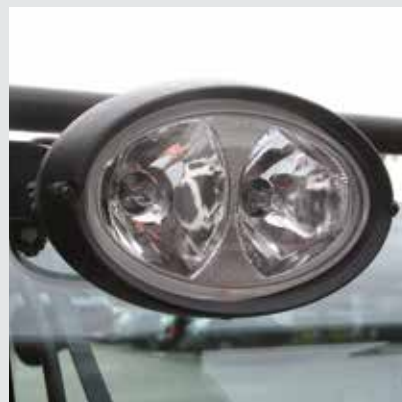
2 pracovní světlomety Dual Power vpředu, 1 pracovní světlomet Single Power vzadu
