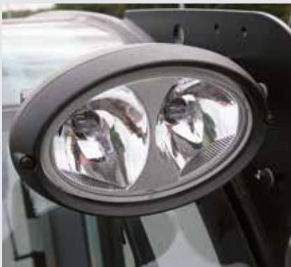
2x pracovní světlomet Dual Power vpředu, 1x pracovní světlomet Single Power vzadu
