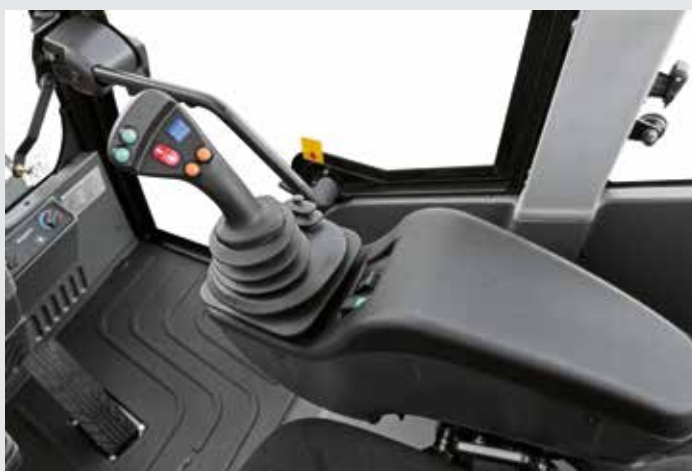
Loketní opěra a joystick tvoří se sedadlem jeden celek a přesunou se při přestavení sedadla. Řidič tak zůstane během dlouhých pracovních dnů déle fit.
