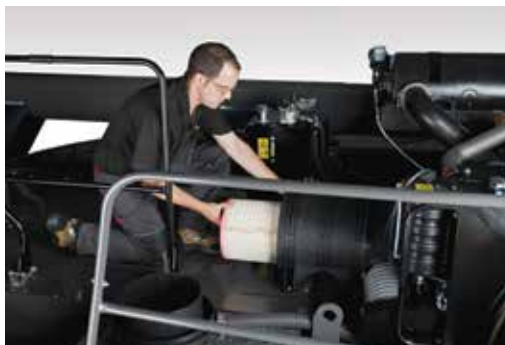
Kontrola a čištění filtru vzduchu
