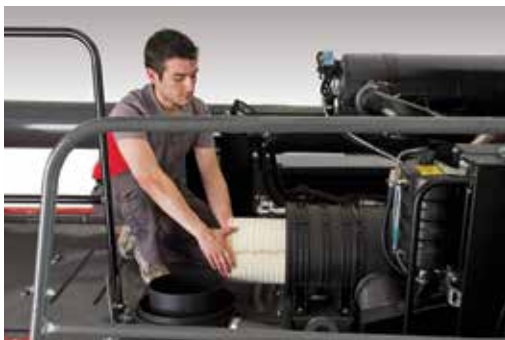
Kontrola a čištění filtru vzduchu
