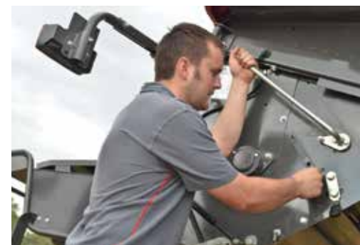
Snadná přestavba mezi řezáním a ukládáním do řádků pro lisování balíků
