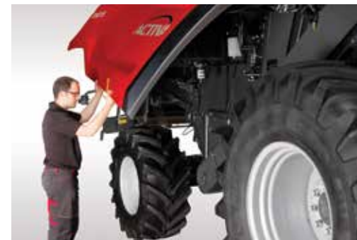
Jednodílné panely s osvětlením umožňují rychlý přístup při kontrole
