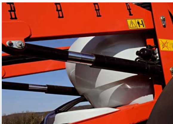
Pístnice paralelogramu vybavená dusíkovým tlumičem rázů
