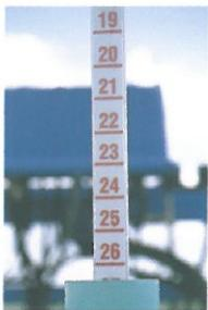
Plovákový hladinoměr s přímým odečtem je instalována standardně
