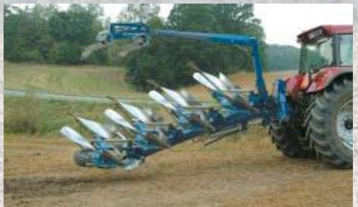
Při horním obracení, kdy se orební tělesa otáčejí nad rámem, je potřeba vyšší zvedací síla než při spodním otáčení (viz strana 3).
