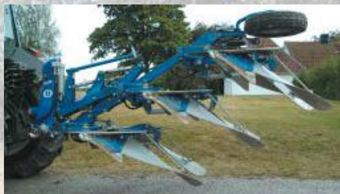
Tím, že se orební tělesa otáčí pod rámem pluhu, je těžiště blíže k traktoru, a k otočení pluhu stačí menší zvedací síla.
