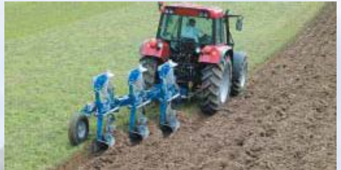
CX 390 H s pološroubovitými orebními tělesy XL a předradličkami EG.
