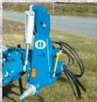
Příčné zajištění pro přepravu.
