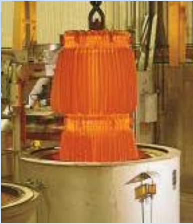
Cementování polotovarů radlic.
