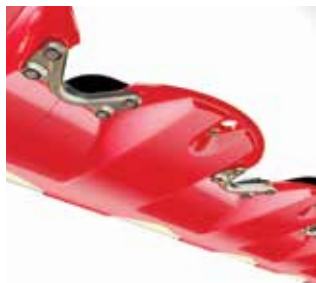
Proudnicový tvar žací lišty (v dolní části)
