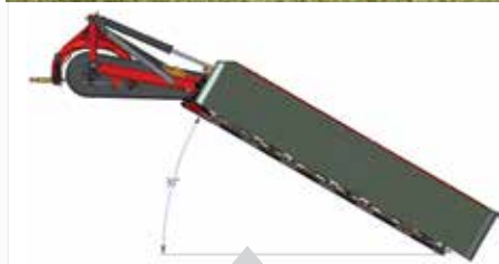
Bočně nesený: umožňuje sečení i na svažitém terénu
