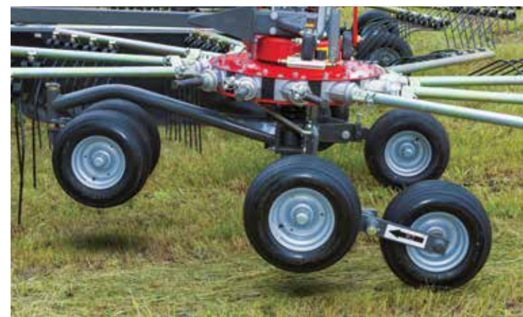
Patentované zavěšení rotoru pomocí kardanů
