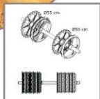
Kruhy CAMBRIDGE Plus jsou novou generací kruhů Cambridge model 2000. Tyto kruhy mají zesílené paprsky a mají pak o 10 % větší hmotnost. Jsou vhodné pro kombinaci s lištou crackerboard a do kamenitých podmínek.
