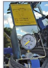
Nyní se natahují vnitřní sekce. Hmotnost se rozdělí v třetinovém poměru na každou sekci. Hydraulika se následně nastaví do pracovní polohy a práce může začít.
