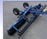
Nyní se natahují vnitřní sekce. Hmotnost se rozdělí v třetinovém poměru na každou sekci. Hydraulika se následně nastaví do pracovní polohy a práce může začít.
