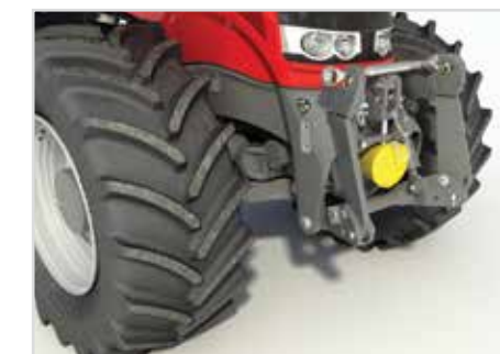
Erfüllen Ihre Anforderungen – voll integriertes Fronthubwerk und Zapfwelle
