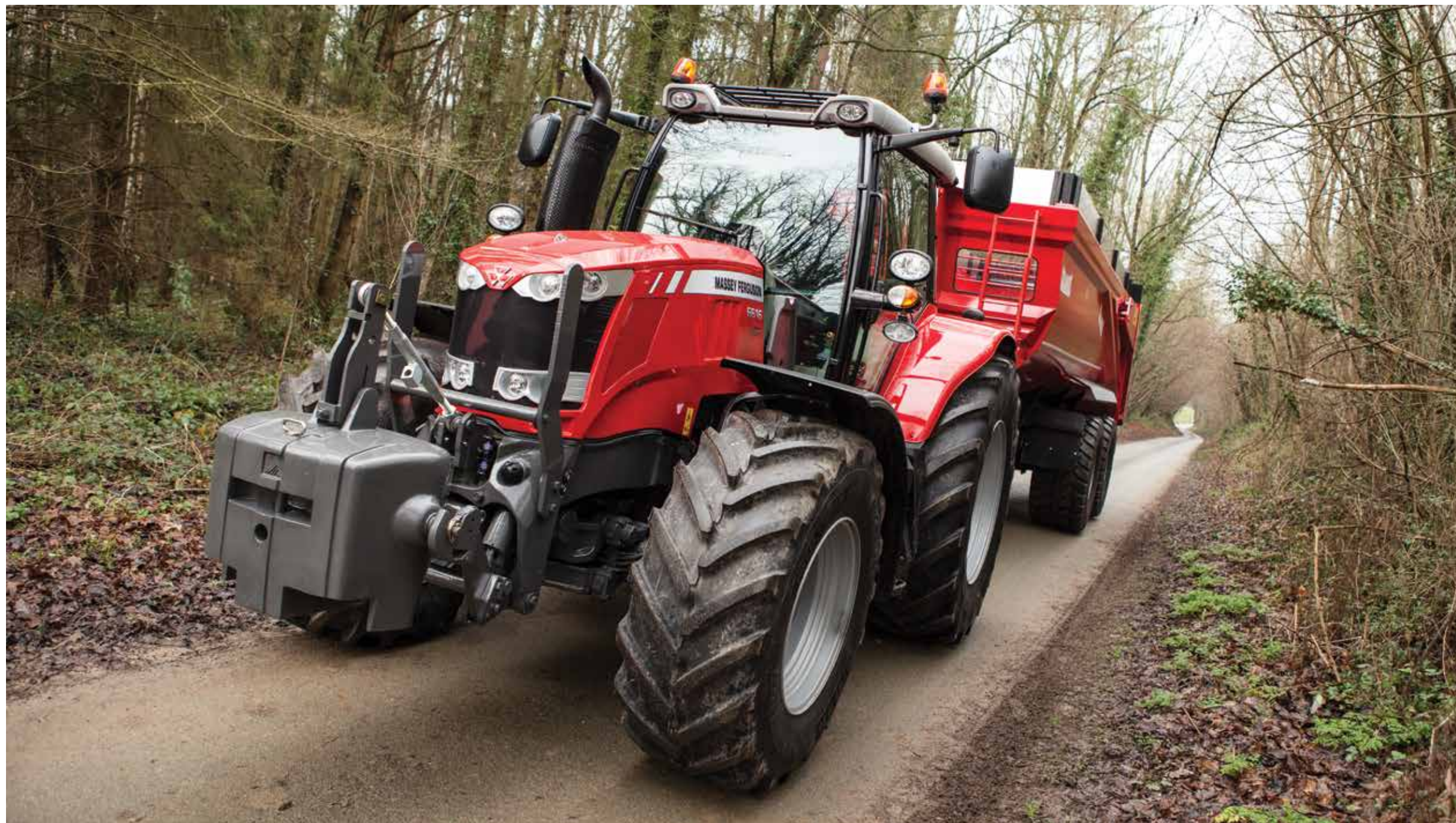
Erfüllen Ihre Anforderungen – voll integriertes Fronthubwerk und Zapfwelle
