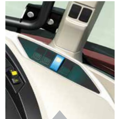
Neue „kombinierte – HighFlow“ Option mit 100 l/min auf Knopfdruck
