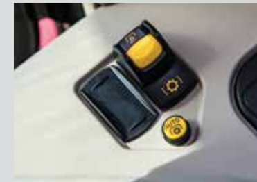
Bedienung mit dem Schalter in der rechten Kabinensäule
