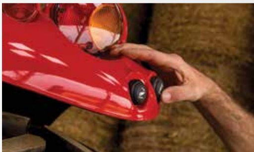
Auf dem Kotflügel montierte Tasten zur Heckhubwerksbedienung
