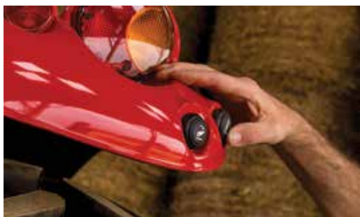
Na blatníku montované spínače vnějšího ovládání zadního závěsu
