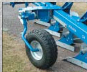
Kombi kolo přesazené do předu. Průměr 710 mm, šířka 264 mm.
