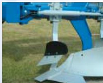
Předradlička EP s umělohmotnou odhmovačkou vhodnou do velmi lepivých půd.
