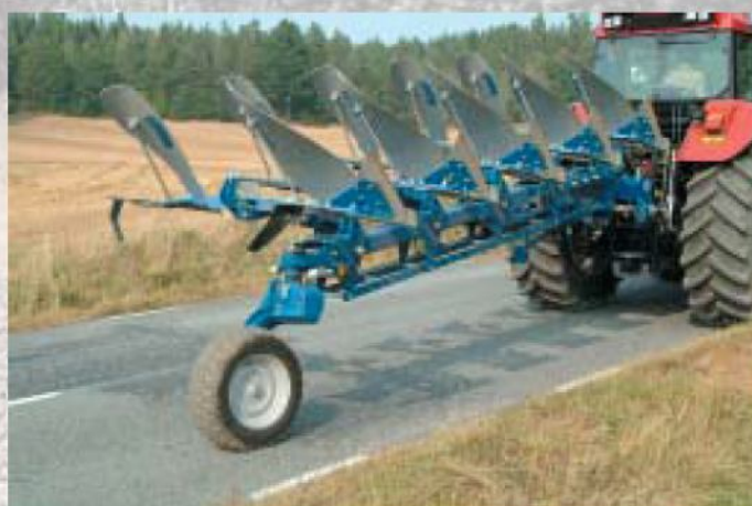
Nové kombi kolo je lehce přestavitelné do přepravní polohy.
