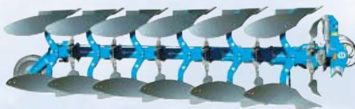
Vari Flex DX 690 F jistěný střížným šroubem. Pracovní záběr je hydraulicky nastavitelný od 1,8 do 3,0 m.
