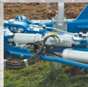
Dvojitý hydraulický válec pro podélné vyrovnání.
