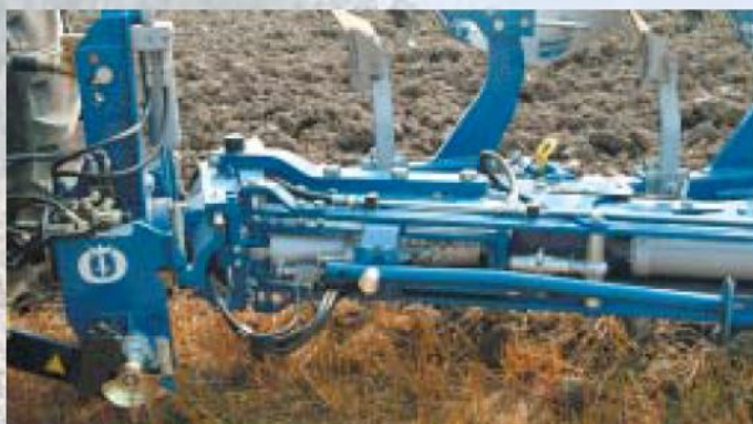
Dvojitý hydraulický válec podélného vyrovnání registruje nastavený záběr. Tahovou linii lze mechanicky nastavit tak, že boční síly jsou eliminovány a pluh je lehce tažitelný.
