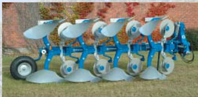
Vari Flex CX 490 F s kotoučovými krojídly a předradličkami EG. Orební tělesa a předradličky jsou jistěny strážným šroubem.
