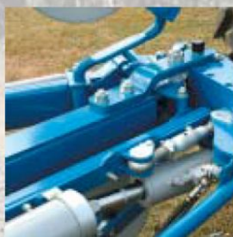
Pohybovým šroubem lze nastavit ideální tahovou linii, aby byly eliminovány všechny boční síly.
