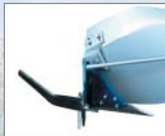
Brázdový nůž pro široké pneumatiky traktoru.
