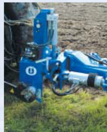
Závěs 3. kategorie, otočná osa o průměru 150 mm, rychlozávěs a válec podélného vyrovnání.
