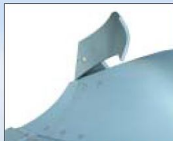
Zaklápěč rostlinných zbytků. Dobře zaklápí slámu, není vhodný do lepivých půd.
