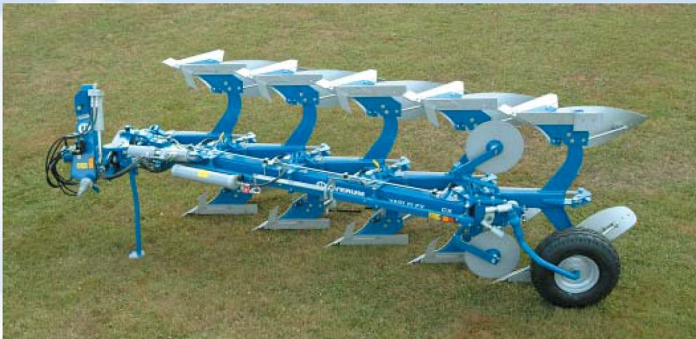
Vari Flex CX 580 H s hydraulicky měnitelnou šířkou záběru od 1,5 do 2,5 m.
