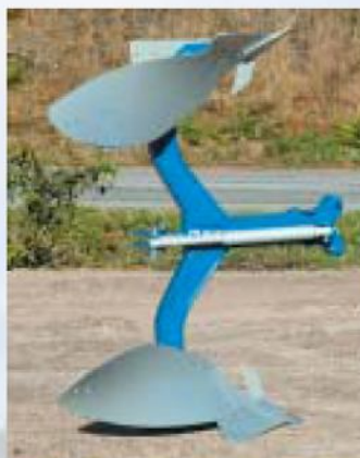
Velký prostor na profilu slupice umožňuje průchodnost velkého množství posklizňových zbytků.
